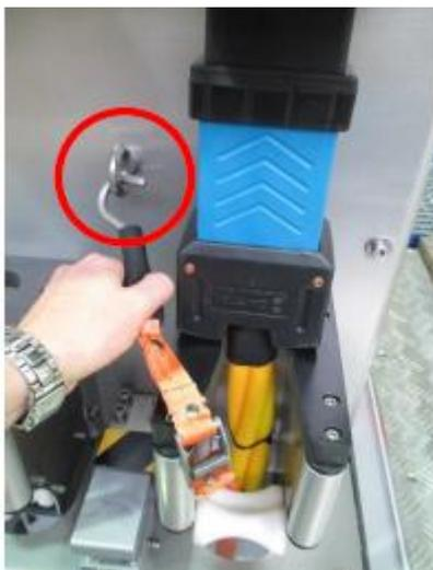
9. Accorciare la cinghia di sostegno stringendola in modo che sia raccolta ma non in tensione.
