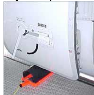
Figura 8 – Posizionamento corretto della safety shoe
