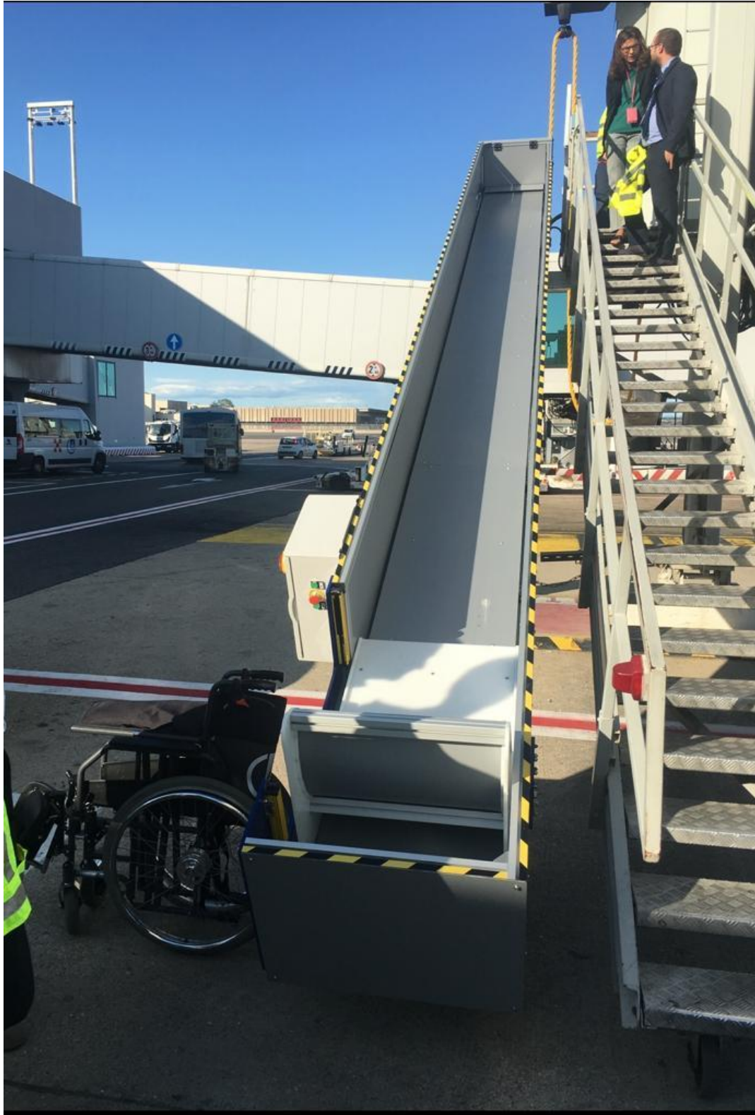
Immagine 5. Situazione iniziale ideale: pedana mobile a fine corsa in basso
