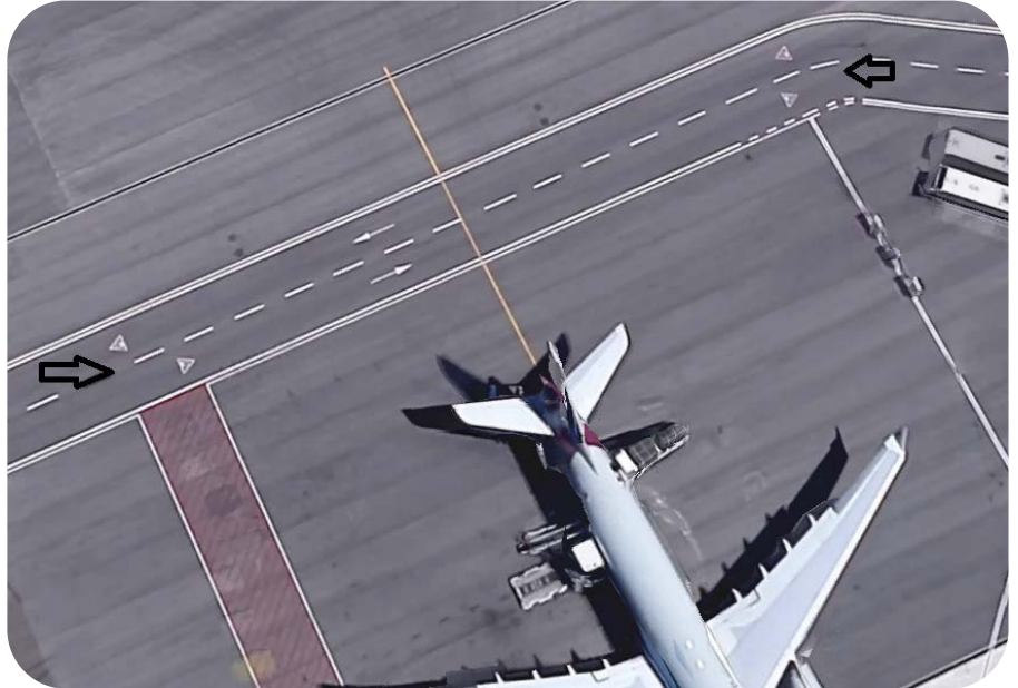
Figura 8 - Segnaletica orizzontale jet blast sulla viabilità
